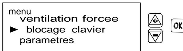
2. Sélectionner à l'aide des touches + et - le niveau souhaité et valider par **OK**. Le blocage est maintenant actif. Quitter le menu en pressant la touche **M**.
