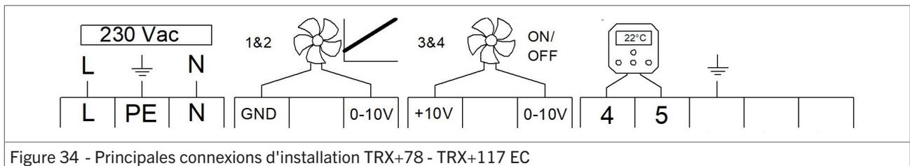
Figure 34 - Principales connexions d'installation TRX+78 - TRX+117 EC
