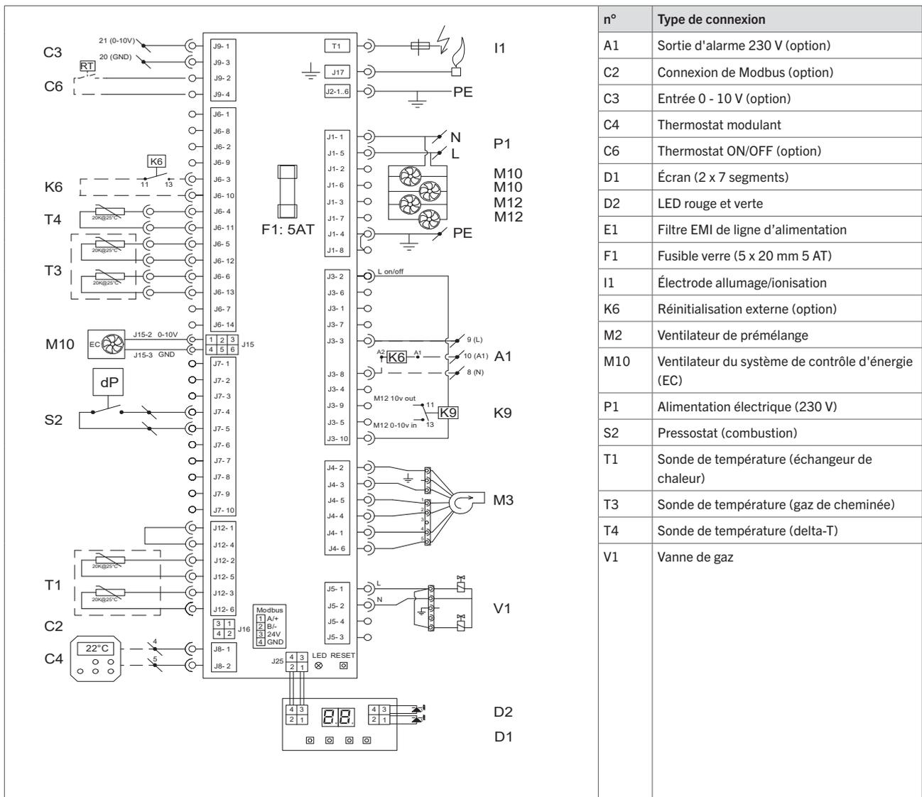
Figure 33 - Schéma de câblage TRX+78 - TRX+117 EC
