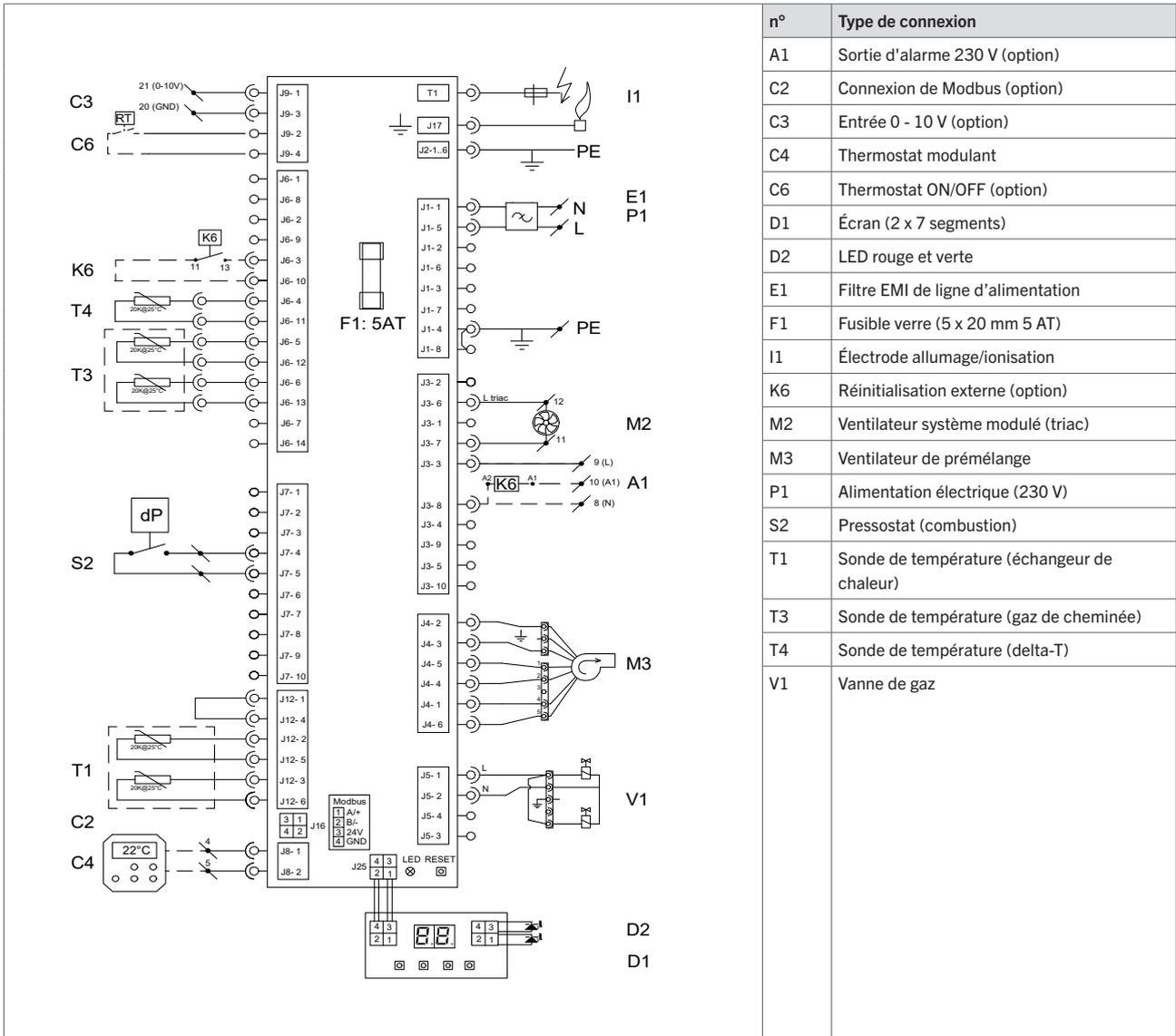
Figure 27 - Schéma de câblage TRX+14 - TRX+65 AC
