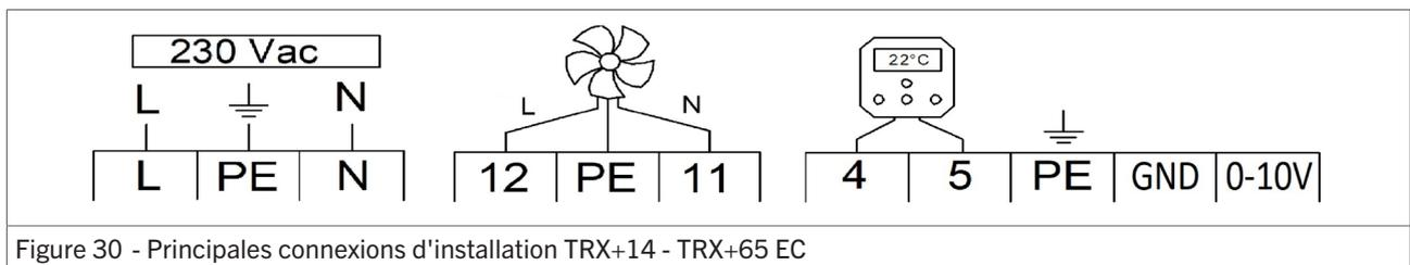
Figure 30 - Principales connexions d'installation TRX+14 - TRX+65 EC
