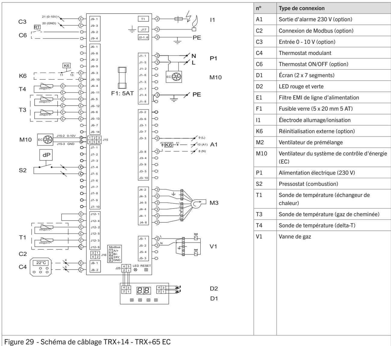
Figure 29 - Schéma de câblage TRX+14 - TRX+65 EC
