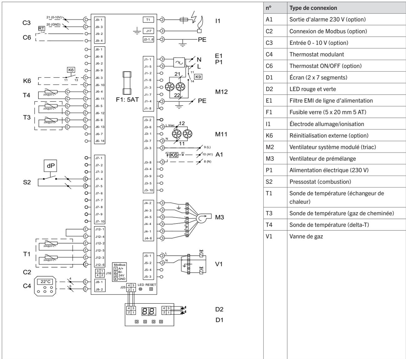
Figure 31 - Schéma de câblage TRX+78 - TRX+117 AC
