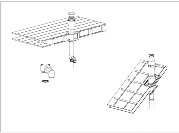
**REMARQUE** Vérifier que le tuyau de gaz de cheminée et le tuyau d'admission d'air ne soient pas interconnectés. Le conduit de gaz de cheminée doit être au centre du terminal de gaz de cheminée.
