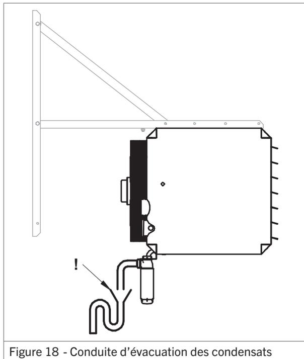
Figure 18 - Conduite d'évacuation des condensats
