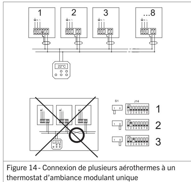
Figure 14 - Connexion de plusieurs aérothermes à un thermostat d'ambiance modulant unique
