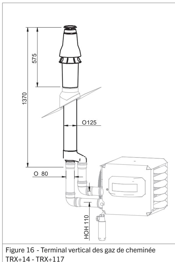
Figure 16 - Terminal vertical des gaz de cheminée TRX+14 - TRX+117
