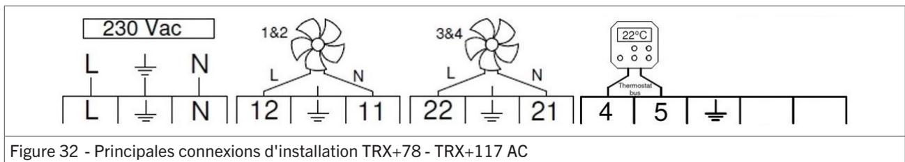
Figure 32 - Principales connexions d'installation TRX+78 - TRX+117 AC
