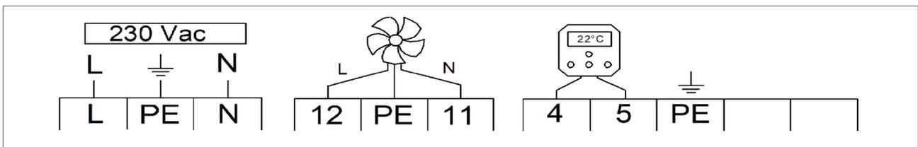
Figure 28 - Principales connexions d'installation TRX+14 - TRX+65 AC
